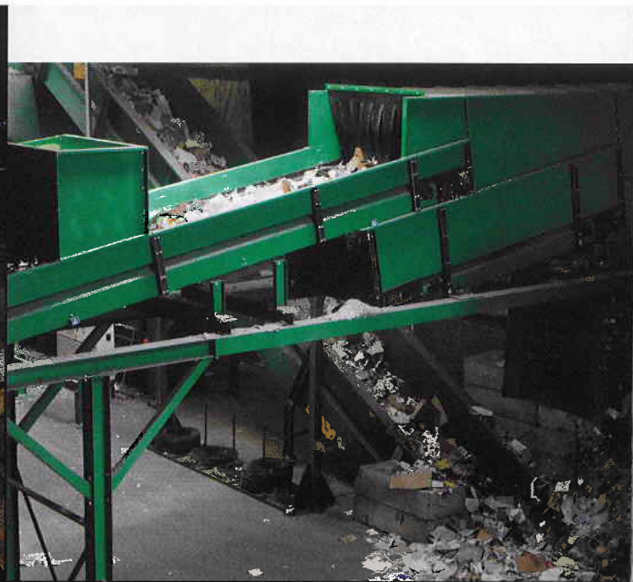
DE LOPENDE BAND LEIDT HET PAPIER NAAR DE SORTEERMACHINE.
